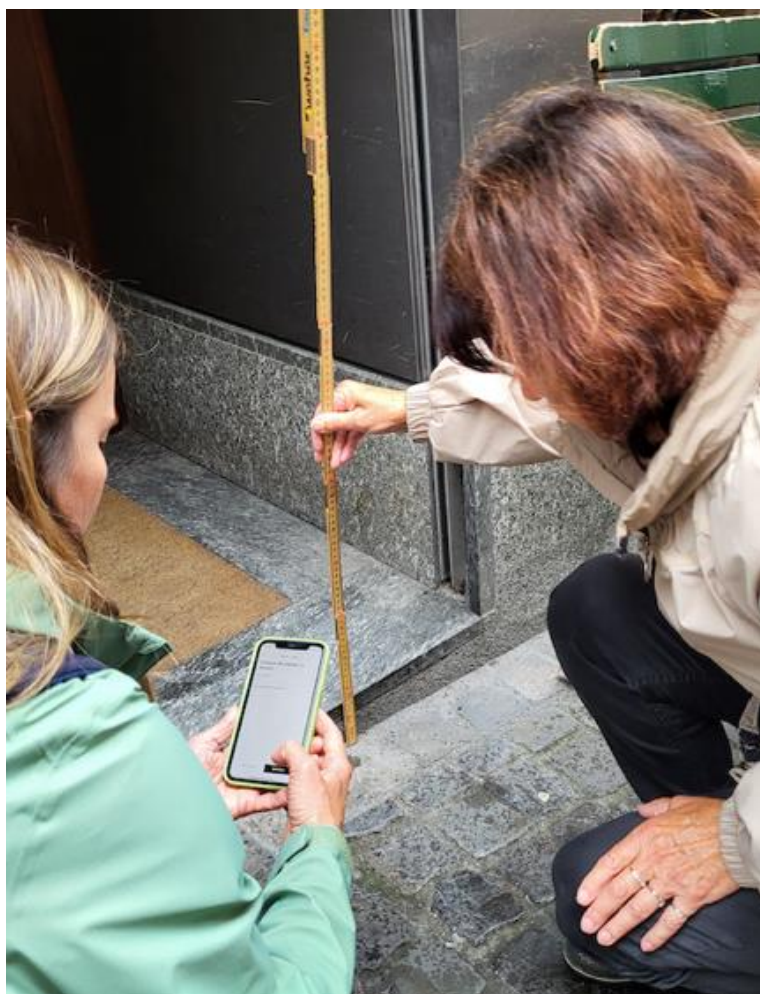
Abbildung 41: Erfassung von über 70 Gebäudezugänglichkeiten über die gintoApp (Quelle: Selina Finsler, Sitios)
